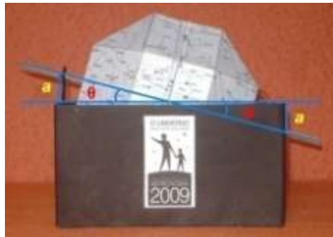
Figura 13 - O ângulo de inclinação – \theta – equivale à latitude do local que se deseja obter a visualização do céu.
