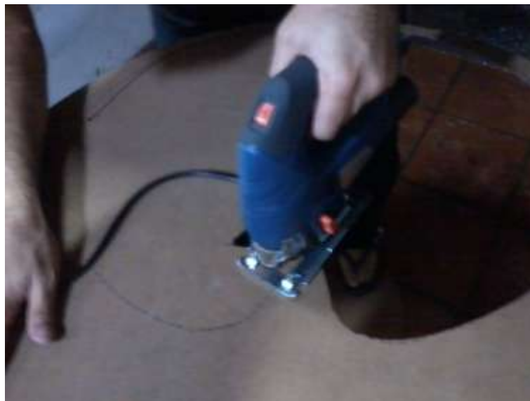
Figura 13 – Cortando a placa de Eucatex com a serra tico-tico
